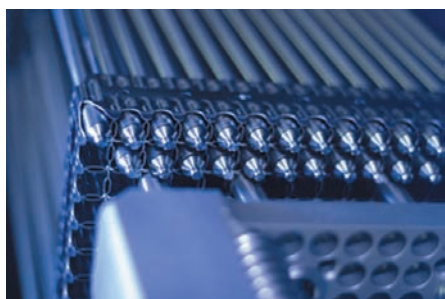
Brennstäbe sind Metallröhren, oft aus Zirkaloy, einer Zirkonium-Legierung. Bei heute üblichen Siedewasserreaktoren können sie rund vier Meter lang sein, bei einem Außendurchmesser von rund 10 Millimetern und einer Wandstärke von einem knappen Millimeter. Eine Feder hält die Pellets aus Urandioxid darin als Säule zusammen und schafft so zugleich Raum für Gase und flüchtige Spaltprodukte, die bei der Spaltung entstehen. Mehrere Brennstäbe werden zu Brennelementen zusammengefaßt. Im Bild ist ein Teil eines Brennelementes dargestellt, das in Druckwasserreaktoren zum Einsatz kommt.
